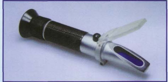
Refractómetro: aparato para controlar la correcta mezcla refrigerante-agua.
